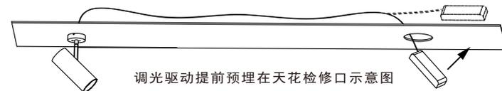
注：由于吸顶盖尺寸限制，MULAN45/55/65吸顶式外置调光驱动时，驱动需提前预埋在天花检修口上引线接通，90吸顶式因吸顶盖内孔尺寸够大，故驱动可以从灯具顶端直接开孔塞进去
