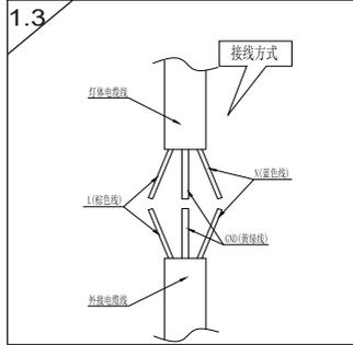
此步骤适用于BL00626/BL00627, 接线前请关闭电源, 接线后请做好防好处理。
